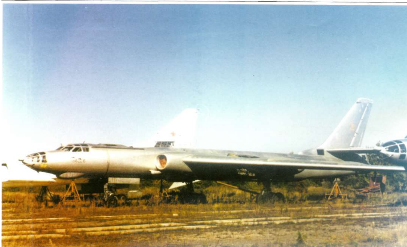
Ту-16, Переоборудованный в мишень. Фото Светланы ЗАРЫВАЛОВОИ.
